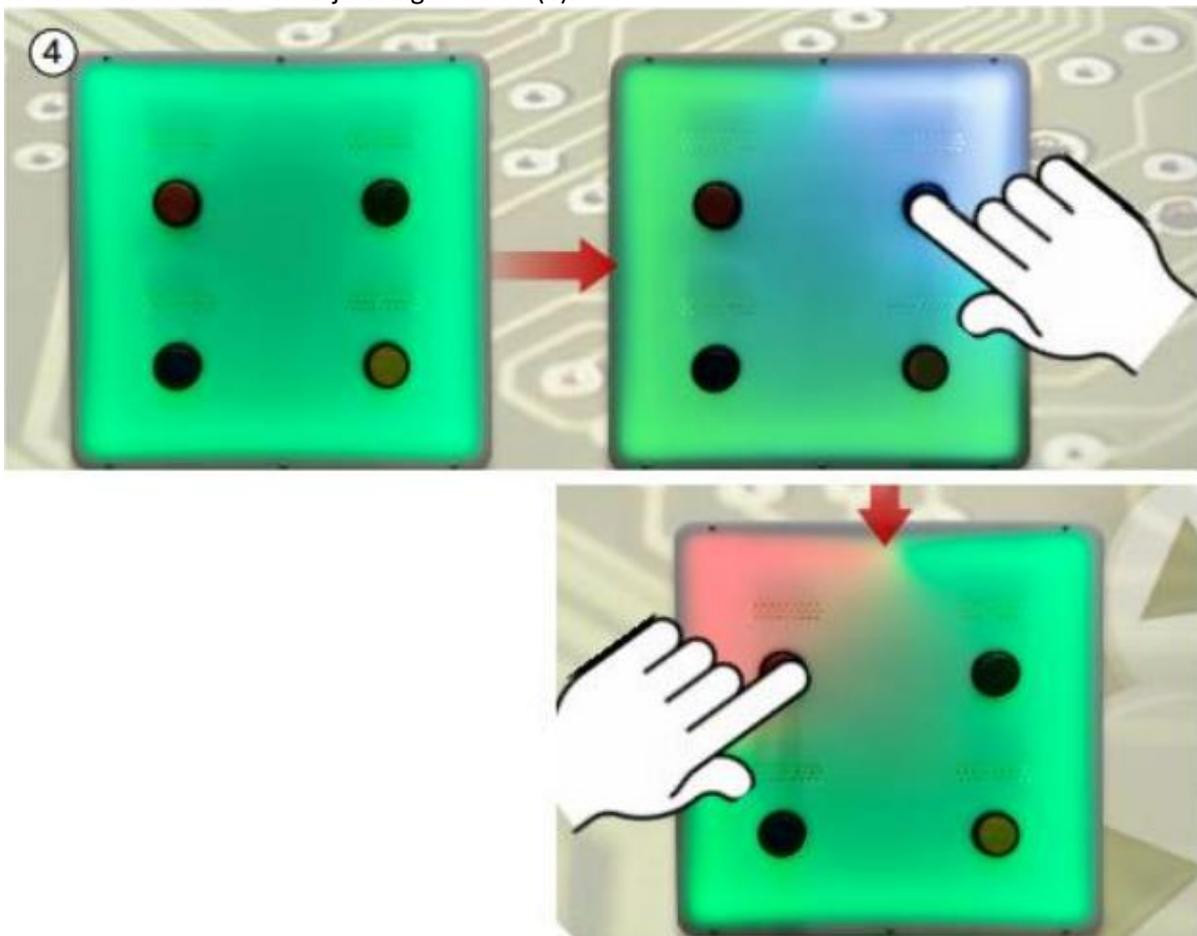
An der Vorderseite des Panels befinden sich 4 robuste Tasten, die jeweils einen farbigen Quadranten steuern. Wenn eine dieser Tasten gedrückt wird, ertönt ein Soundeffekt, die LED-Farbe leuchtet heller und der interne Ventilator bläst den Duft aus der entsprechenden Lüftungsöffnung. Der Ventilator läuft, solange die Taste gedrückt gehalten wird (2).
