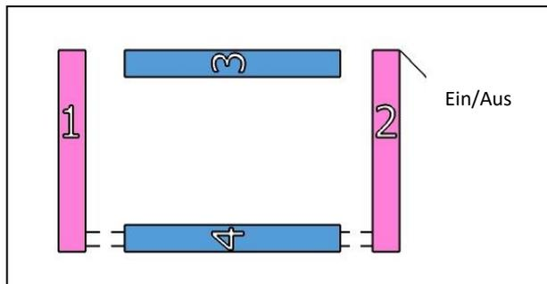
3. Verbinden Sie die 2 Kabel von Block 4 mit denen von Block 1 und verbinden Sie auf die gleiche Weise die 2 Kabel von Block 4 mit denen von Block 2.
